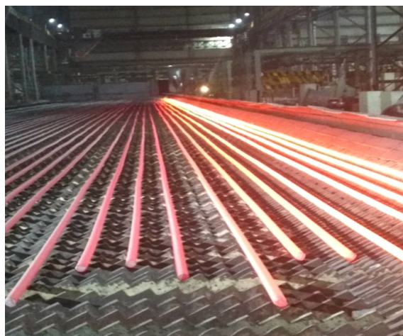
攀钢钢筋生产线（上冷床温度950°C左右， \phi 25\text{mm} ）
