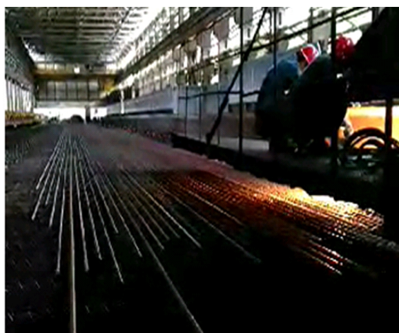
穿水钢筋生产线（上冷床温度650°C左右， \phi 25\text{mm} ）
