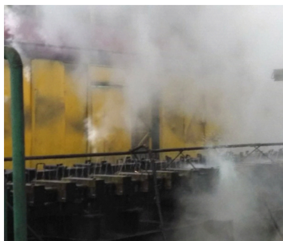
穿水钢筋生产线（上冷床温度650°C左右， \phi 25\text{mm} ）
