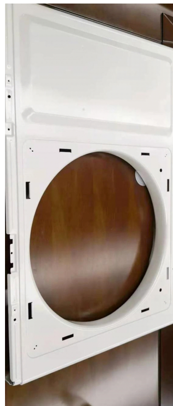
空调外机面板
