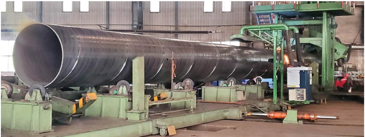
成型焊接中的油气管
